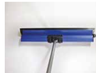
Mennyezetén is széles simítóval elhúzott 2-3 mm vastag glettelés, vékonyvakolat.
